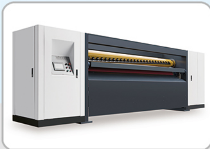
SNS-77HD 雙座式電腦伺服修邊壓線機 NC Slitter Scorer
