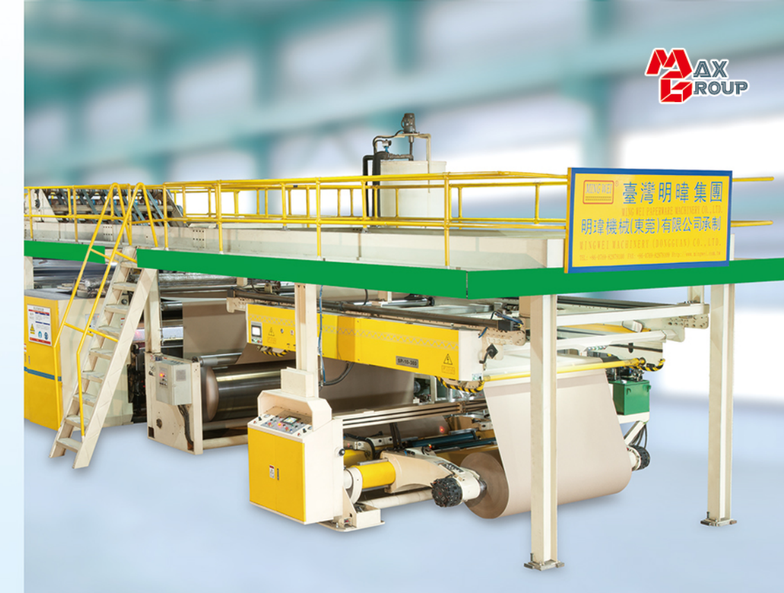
BC-7 天橋輸送部 Overhead Bridge Conveyor
