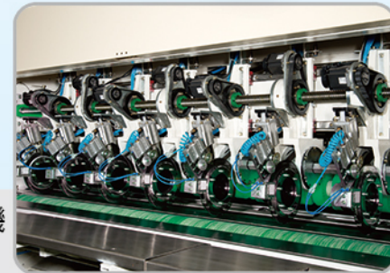
SNS-77HD 雙座式電腦伺服修邊壓線機 NC Slitter Scorer
